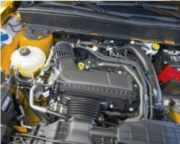
Motor 2.0 turbo entrega 253 cavalos de potência e 380 Nm de torque
