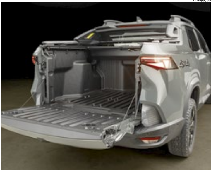
Caçamba tem capacidade de 938 litros e suporta até 654 kg de carga
