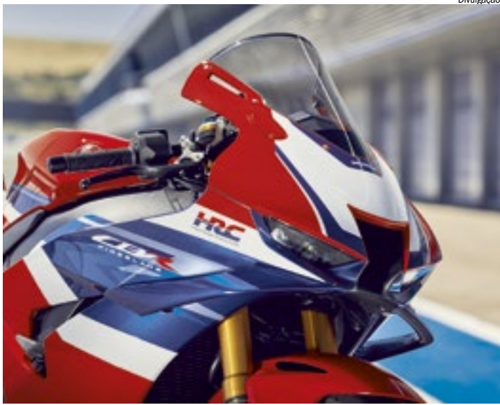
Seção central da carenagem foi redesenhada e abriga novas aletas
