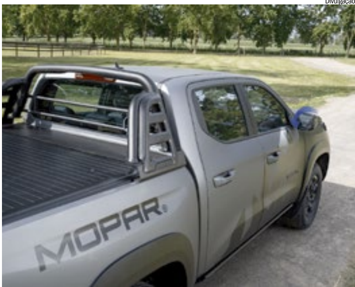
Tilt down abaixa o retrovisor quando o motorista engata a ré
